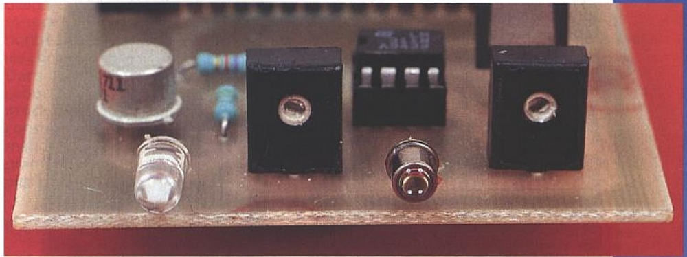
■ Une LED IR, un phototransistor et un comparateur, cela reste simple !
