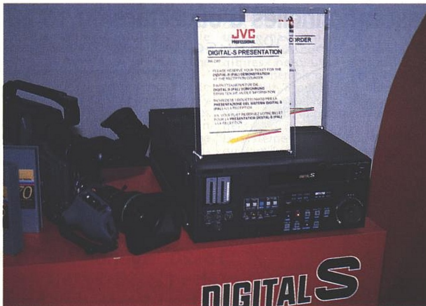
JVC : la gamme «Digital S», avec cassette S-VHS à bande 1/2 pouce à particules métalliques.
