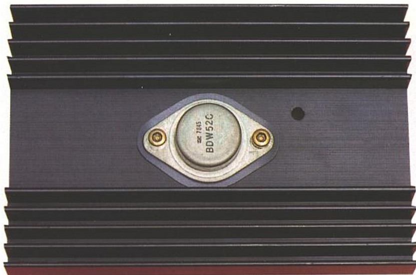
■ Le côté face avec le ballast sur son radiateur.
