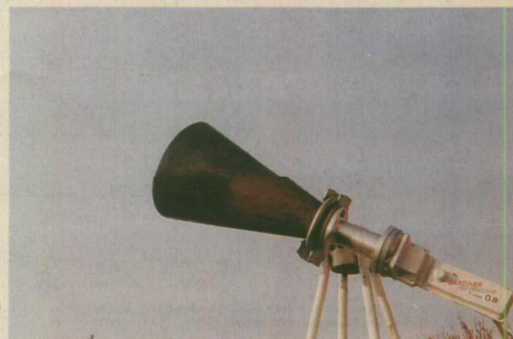
Cornet étalon de 11 cm de diamètre couplé à un convertisseur à 12 GHz dont la figure de bruit est de 0,8 dB, via un système de dépolarisation à vis.
