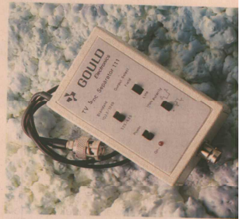
Le séparateur de synchro TV bien pratique pour les mesures et tests en vidéo.
