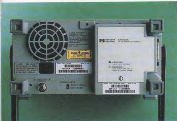
La face arrière équipée de l'interface IEEEEE. Cette dernière assure aussi la sauvegarde des traces.
