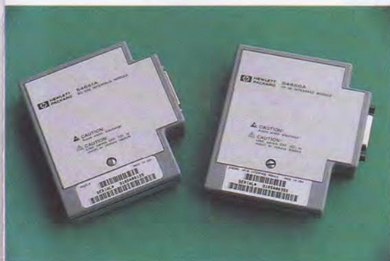
Les modules d'interface RS 232 et IEEE.
