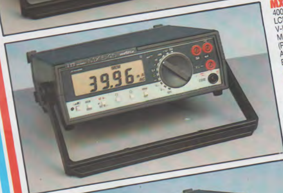
MX 547. 4000 points autoranging. LCD 20 mm. V-I, \Omega test diodes. Mémorisation de la mesure (Peak-Old). Valeur efficace RMS AC/AC + DC. Mesure de température avec couple K - 20° + 400 °C. Alimentation secteur. Batterie option.
