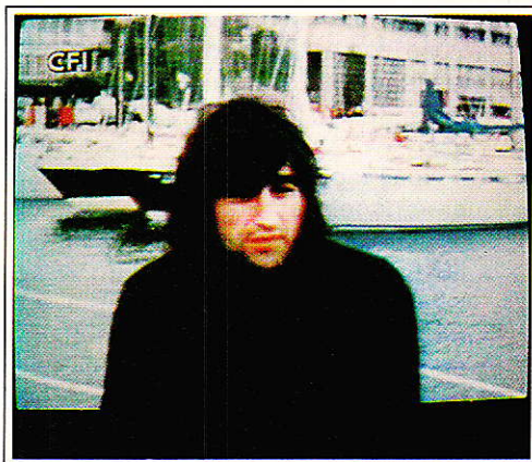
Réception avec une parabole de 1,80 m de Ø à Strasbourg. Le démodulateur utilisé est le ESR 3240 E dont la bande vidéo a été ramenée à \approx 12 MHz.
