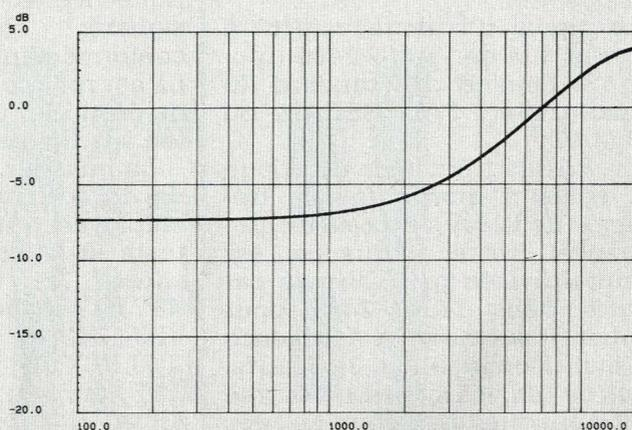
Figure 15 - Courbe de précompensation 50  $\mu$ s.
