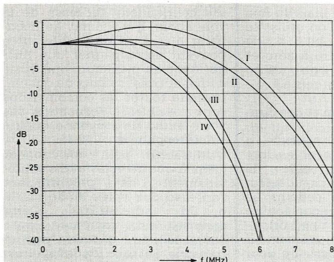
Figure 8 - Courbe de réponse des filtres luminance.
