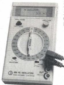
**555 RC.** Générateur portable de 20 Hz échelonnées en 46 fréquences fixes. Sinus et carré. Atténuateur - 20 dB. Taux de distorsion à 15 kHz : 0,05 % à 150 kHz : 0,3 %.
