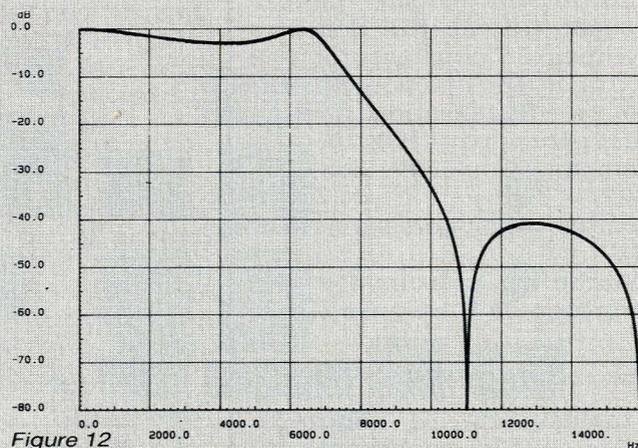
Figure 12 - Courbe de réponse des filtres de surechantillonnage.
