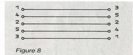
Il ne restera plus alors qu'à acheter ou réaliser d'après la **figure 8** le cordon DIN croisé permettant le raccordement au MINITEL, ou à un maillon du « réseau MINITEL ». Un essai pourra être fait en frappant quelques touches puis en envoyant un « retour chariot » par pression simul-
