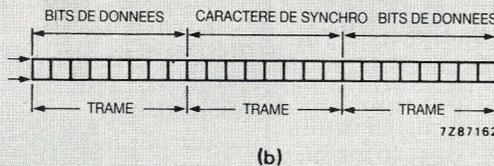
Exemple de format de transmission série asynchrone (a) et synchrone (b).
