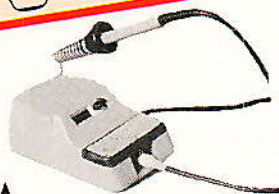
TCSU-D. Poste de souder à température contrôlée avec affichage digital des températures de la pointe de la panne. Ce poste très compact offre la possibilité de bloquer la température de soudage choisie. Construit autour d'un dispositif spécial fait pour Antex par Ferranti. Gamme de température : ambiance à 450°C ± 5°C. Voltages 220-240 V. 1352 F
