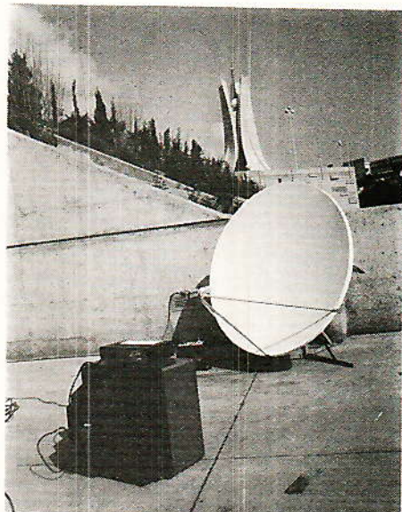
Monture fixe : on remarque, ici à Alger, que le convertisseur Telecom 1C est placé presque à l'horizontale ( \alpha = 15^\circ )
