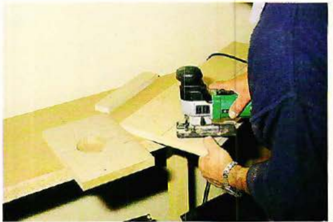
Les ouvertures sont pratiquées à l'aide d'une scie sauteuse électrique. Il sera préférable de percer un trou de petit diamètre pour engager la lame. L'ouverture nécessaire au tweeter doit comporter deux passages diamétralement opposés pour les câbles.
