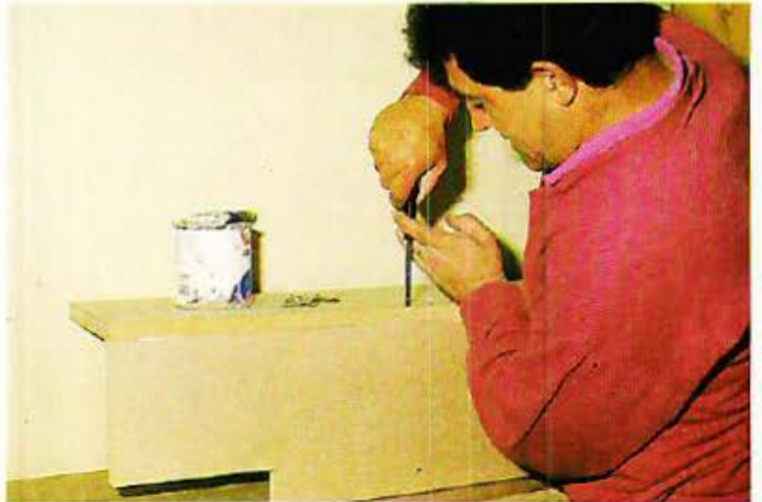
La première phase d'assemblage consiste à rendre solidaires les flancs et le fond (collage et vissage). Vérifier l'équerrage et bien placer les flancs au bord des arêtes du fond.
