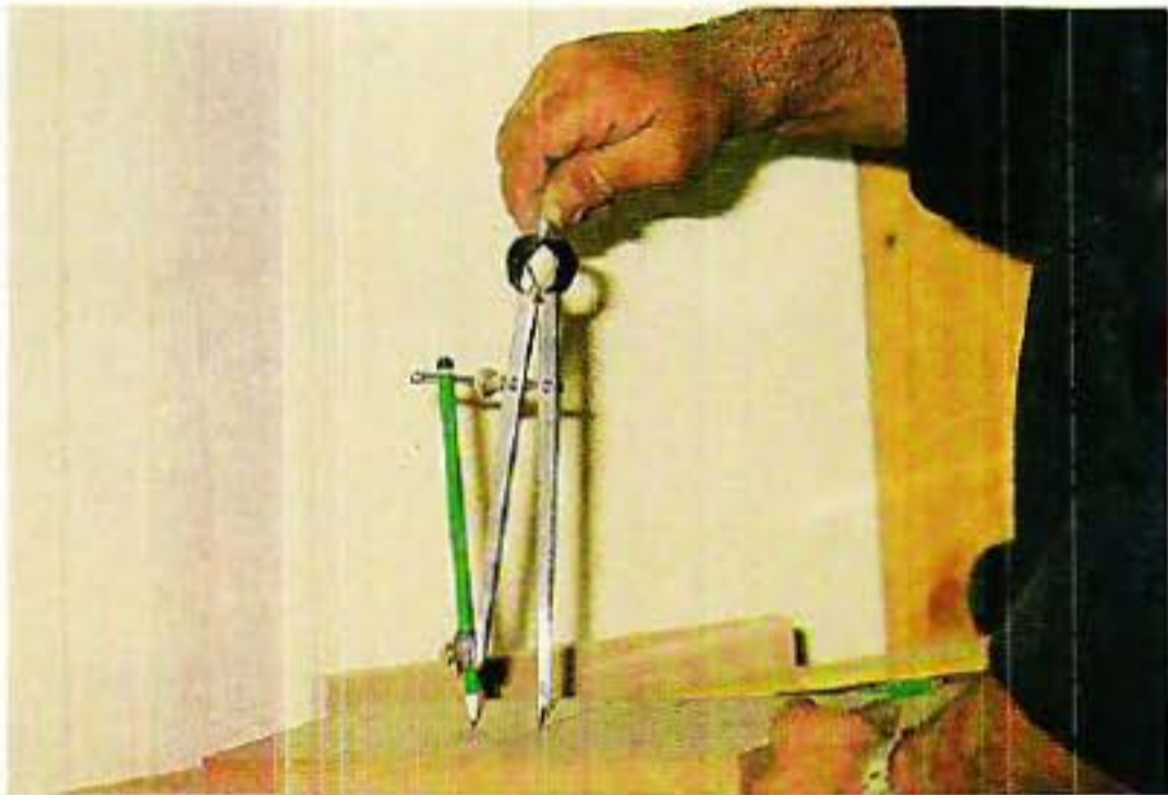
Traçage au compas des ouvertures pour les haut-parleurs et l'évent.
