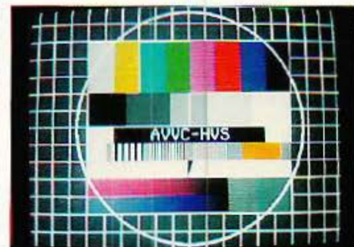
Mire d'une chaîne transmise par le satellite Eutelsat 1 F1 captée dans le Sahara à — 7 dB du point de visée. Réception avec une parabole de 1,80 m.
