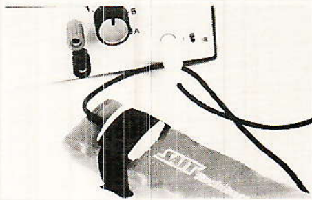
Détail de la sonde thermique, le capteur de température est collé dans un douillet nid de mousse. Le Velcro est collé, côté crochets et envers sur la mousse. La face velours s'y accroche, on referme le tout pour former un bracelet.
