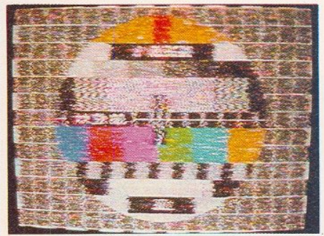
Référence d'une qualité d'image au moyen d'un convertisseur ayant un facteur de bruit donné de 2.5 dB depuis une parabole volontairement dépointée à la limite de la perception de la mire M6
