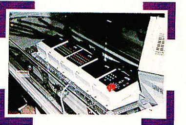
Chez Märklin un système de pupitre de commande numérique pour réseau de chemin de fer. L'un des boîtiers peut être un interface pour micro-ordinateur.
