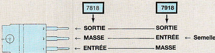
Figure 10 - Brochage des régulateurs intégrés (vu de dessus).
