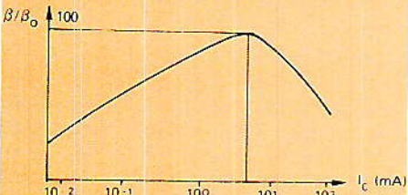
Figure 43 : Linéarité Entrée/Sortie du gain du transistor.
