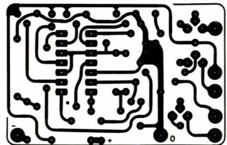
Fig. 9 - CI et implantation du transformateur Millerieux SD 141 B.
