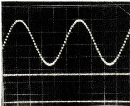
sup - signal de sortie du filtre à 4 kHz 2 V/div
