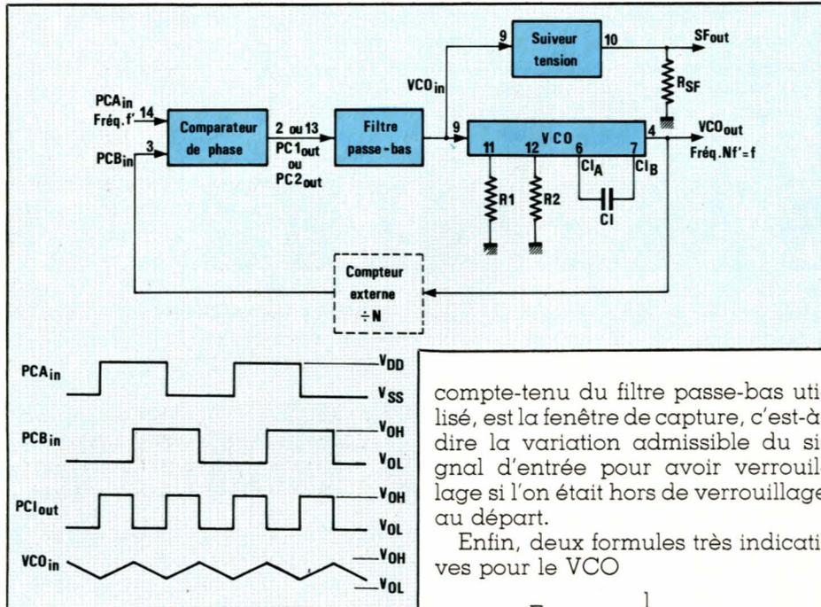
absolument éviter d'avoir un verrouillage possible sur les harmoniques en éliminant celles-ci par un procédé simple ; ne pas les inclure dans la fenêtre  $F_{MAX}$  à  $F_{MIN}$ .
