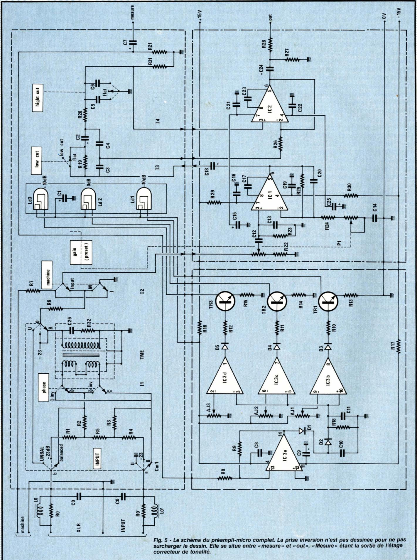
Fig. 5 - Le schéma du préampli-micro complet. La prise inversion n'est pas dessinée pour ne pas surcharger le dessin. Elle se situe entre « mesure » et « out ». « Mesure » étant la sortie de l'étage correcteur de tonalité.
