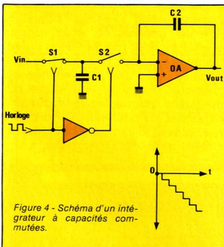
Figure 4 - Schéma d'un intégrateur à capacités commutées.
