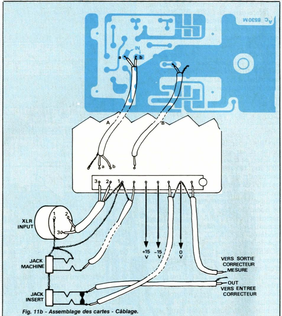
Fig. 11b - Assemblage des cartes - Câblage.
