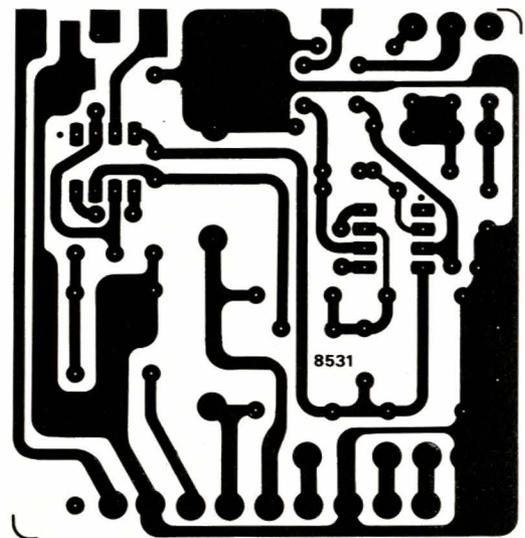
Fig. 8 - CI et implantation de l'indicateur de niveau.
