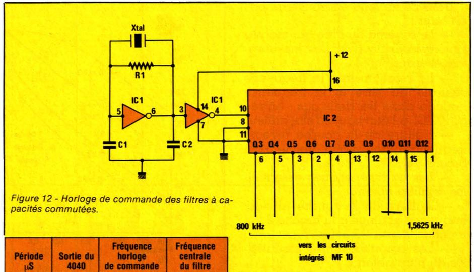
Figure 12 - Horloge de commande des filtres à capacités commutées.
