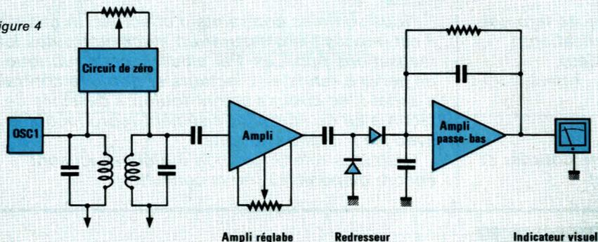
table que le gain soit réglable est suivi d'une cellule de redressement, puis d'un filtre passe-bas pour éliminer l'ondulation résiduelle éventuelle et d'un galvanomètre (figure 4). Vous disposez ainsi d'un détecteur de métal extrêmement sensible à détection visuelle. Détecter une pièce de 10 F à 30 cm avec une tête de 20 cm de diamètre devient possible. Cet appareil détecte indifféremment les métaux ferreux et non ferreux. En jargon de détection le terme utilisé est « toute détection ».
