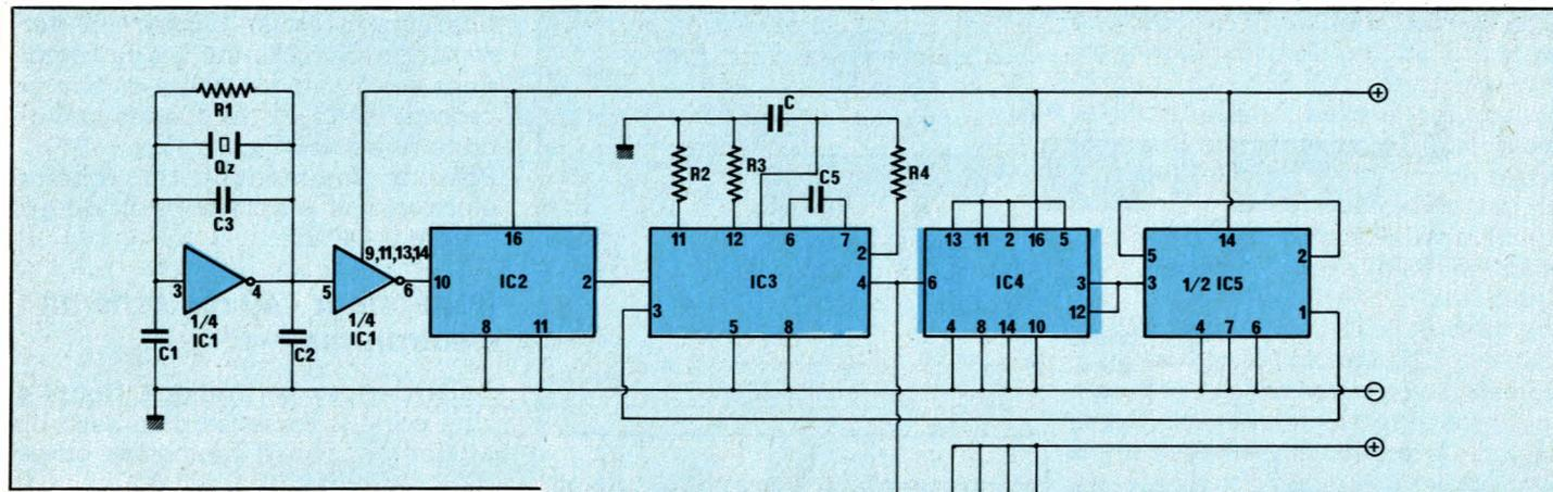
toutes les N impulsions d'horloge sur (6). On a division de fréquence mais loin d'avoir un signal carré. Celui-ci sera obtenu par le 4013 suivant, qui de plus divise la fréquence par deux, ce qui aboutit à un rapport global de 22, le signal divisé étant injecté dans l'entrée libre du compteur de phase PLL. Un autre 4526, associé à l'autre moitié du 4013 en flip flop, divise suivant le même principe le 8800 Hz en 440 Hz.
