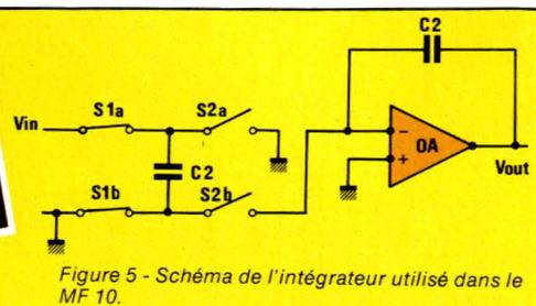
Figure 5 - Schéma de l'intégrateur utilisé dans le MF 10.
