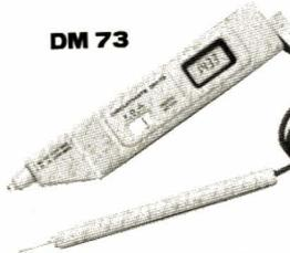
• Multimètre-sonde à commutation automatique (Vcc, Vca, R) • 0,5 % de précision en Vcc • Bouton de maintien d'affichage • Test de continuité (buzzer).
