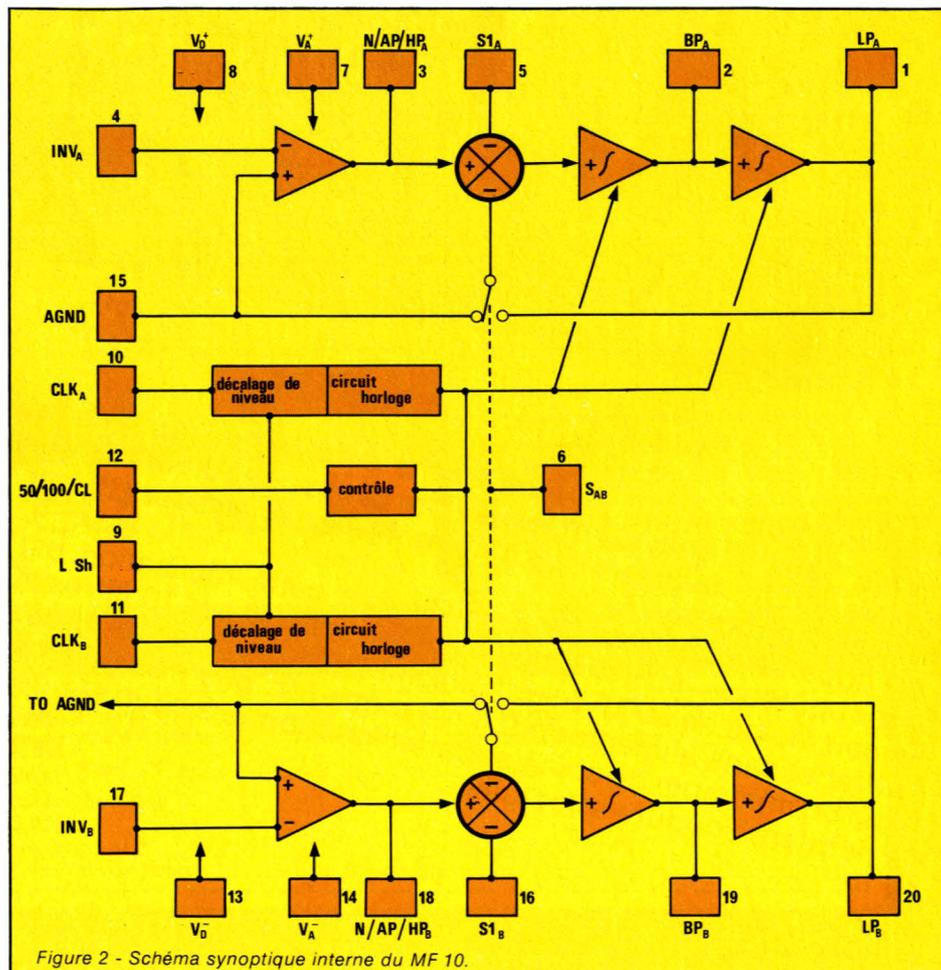
quence. Une horloge est utilisée pour contrôler la constante de temps des deux intégrateurs non inverseurs. Pour bien utiliser le MF 10, il est important de bien connaître son fonctionnement.
