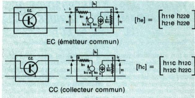
Cette symbolisation n'est valable que si à la fréquence ou à la bande de fréquences de travail considérée, l'alimentation continue de polarisation se comporte comme un court-circuit vis-à-vis de l'alternatif et que la borne commune le soit effectivement en alternatif. (Ce qui suppose des découplages efficaces.)
