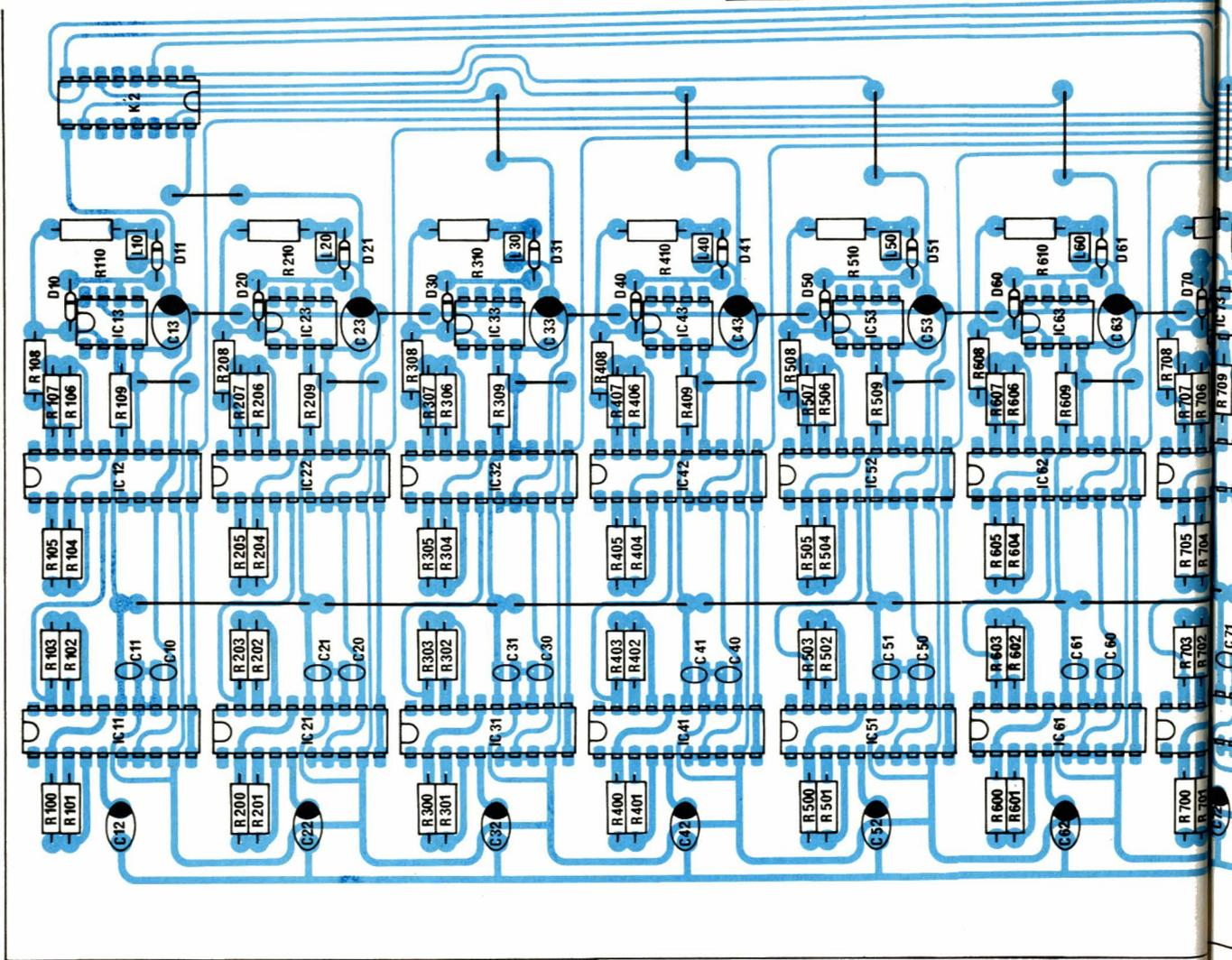
Figure 15 - Tracé des pistes du circuit imprimé.
