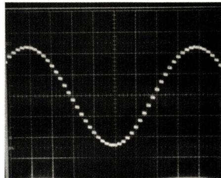
Sortie du filtre 2 kHz 1 V/div
