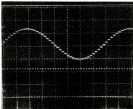
sup - sortie du filtre 2 kHz 2 V/div
