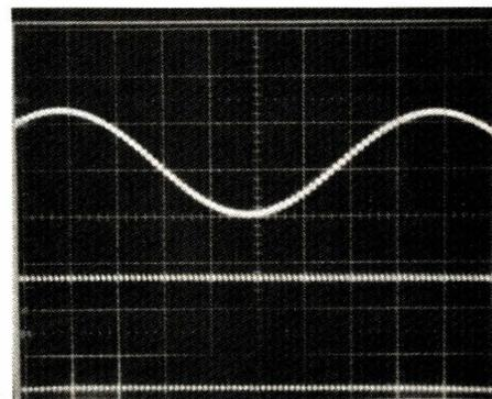
sup - signal de sortie du filtre à 8 kHz 2 V/div
