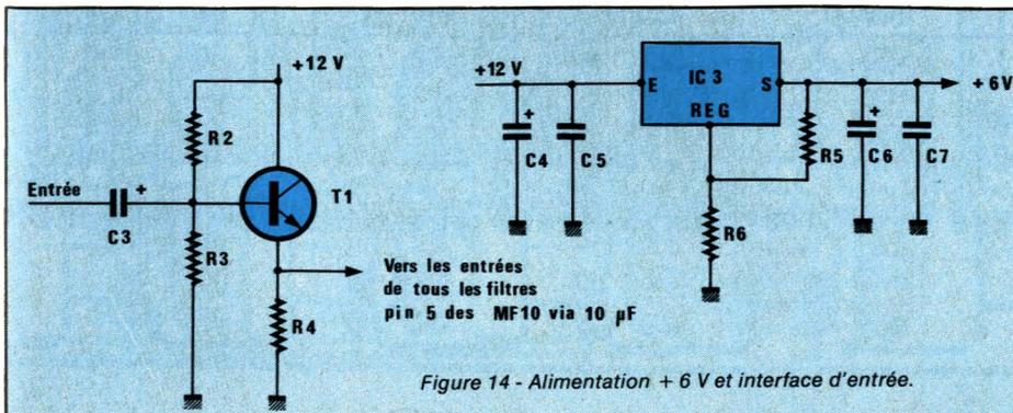
Figure 14 - Alimentation + 6 V et interface d'entrée.
