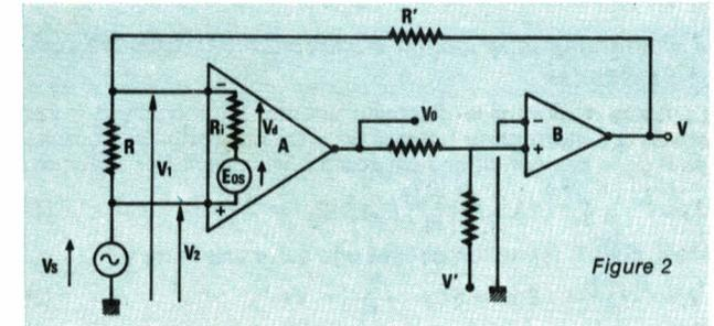
Pour déterminer  $V_d$  et  $V_c$ , nous devons d'abord obtenir  $V_1$  et  $V_2$ . Or, en utilisant le principe de superposition :
