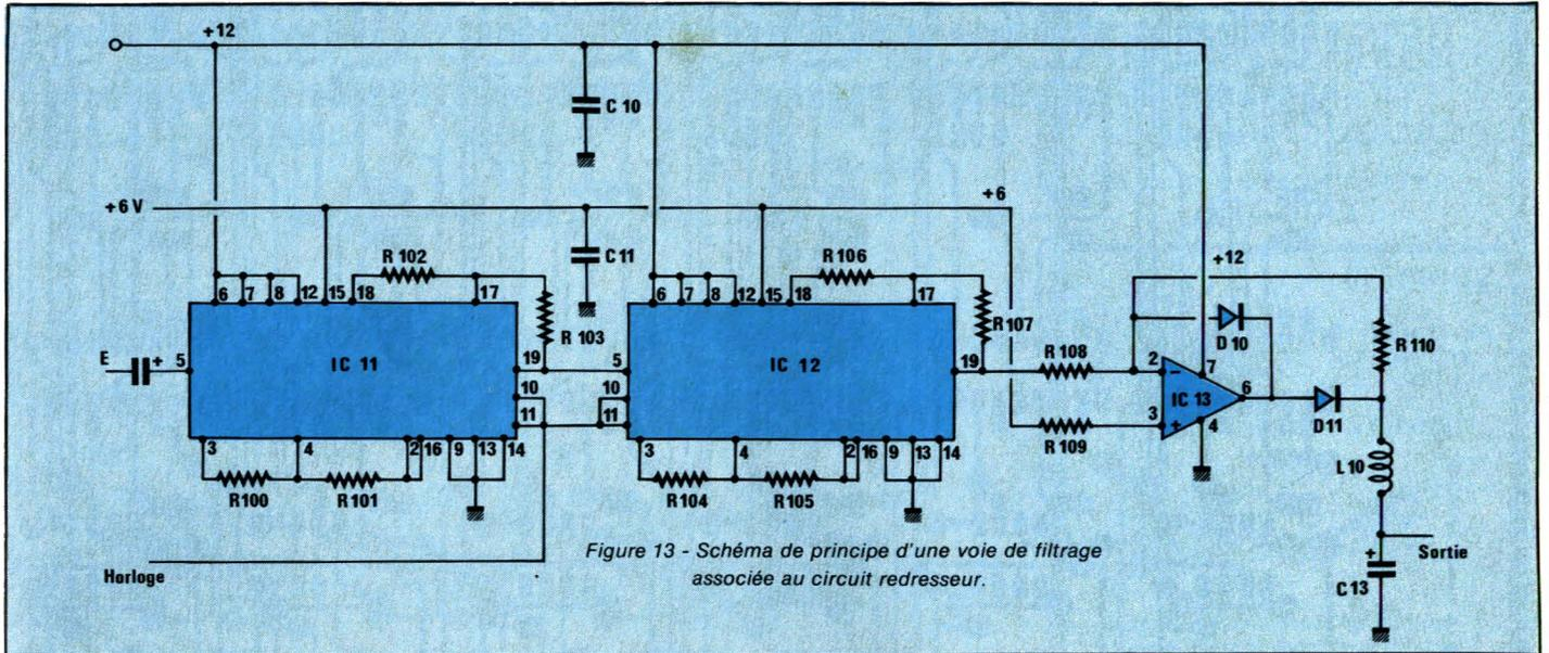
Figure 13 - Schéma de principe d'une voie de filtrage associée au circuit redresseur.
