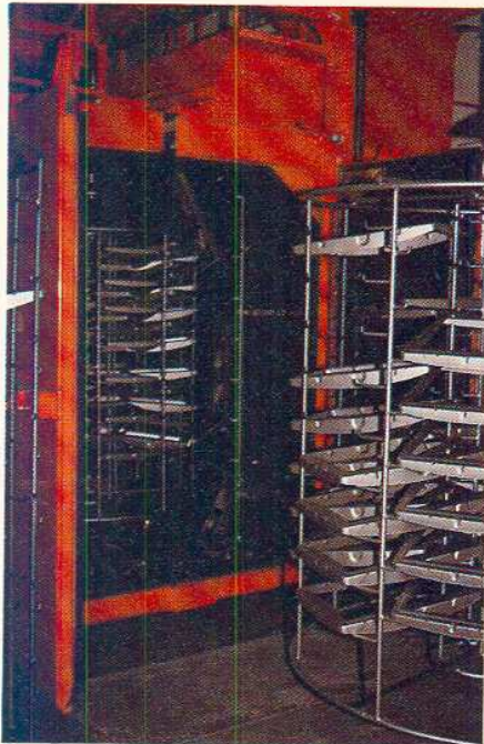
Étuvage des cadres métalliques (masque). Sortie du four.
