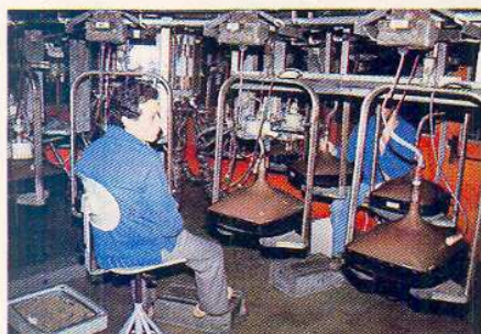
Le contrôle électrique : tensions d'isolement et émission.
