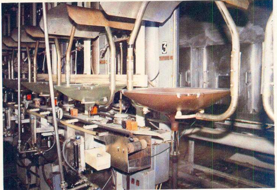
Dépôt de l'oxyde ferrique sur la surface interne du cône.
