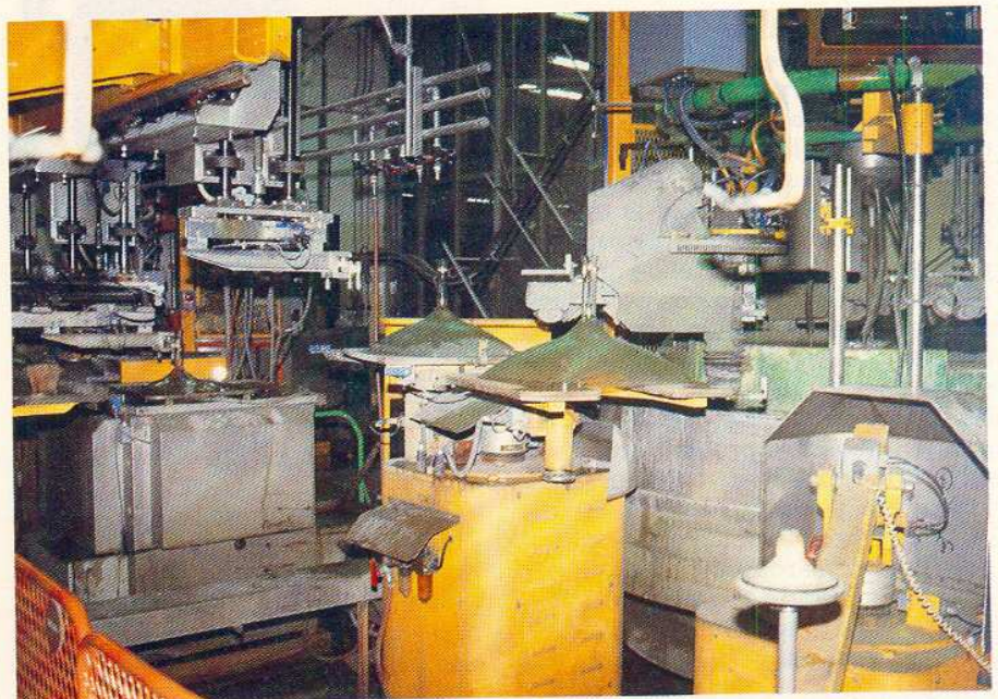
Abrasion, surfacage des cônes, le manchon est déjà soudé au cône.
