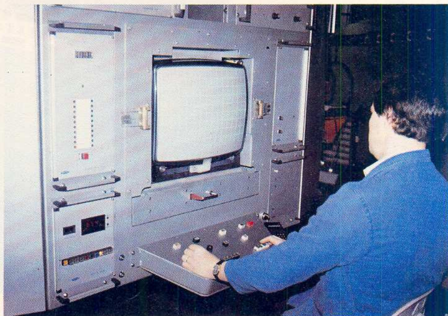
Le contrôle électrique : tensions d'isolement et émission.
