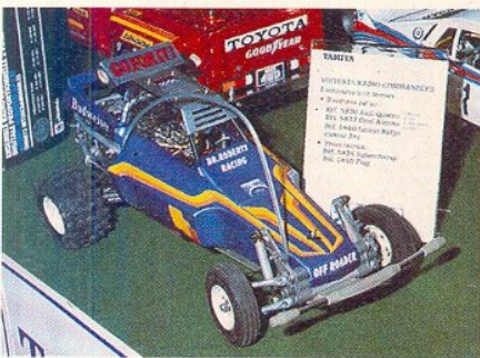
La Super Champ de Tamiya, encore un modèle d'une haute sophistication avec, par exemple une réserve d'huile pour l'amortisseur arrière, à cause de la suspension à amortissement progressif.
