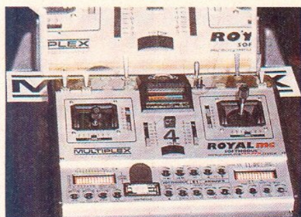
Le nouveau Royal de Multiplex, une version PCM que l'on spécialisera dans des fonctions complexes par logiciel. Pour une somme de 200 à 250 F, on passe de l'émetteur d'hélicoptère à celui de planeur.
