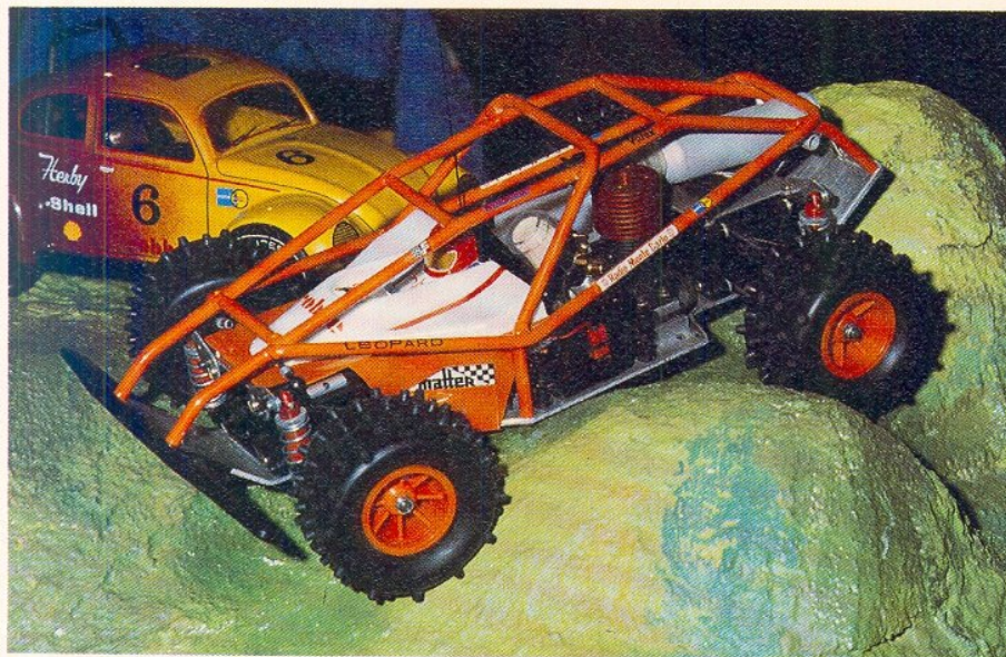
La tout terrain Léopard de Robbe marque l'entrée de SG dans le domaine du tout terrain. Existe en 4 x 2 ou 4 x 4. Propulsion par moteur à explosion 3,5 cm 3 .
