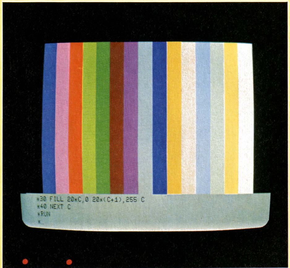
Mire des barres verticales générée par un micro-ordinateur.
