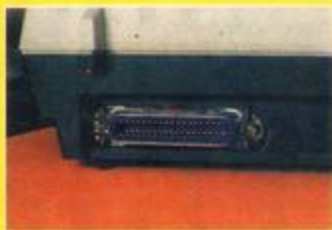
Figure 2 - Le connecteur normalisé de l'interface Centronics permet à la GP 100 de fonctionner en liaison avec la plupart des ordinateurs du marché.
