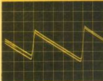
Voie X : 2 ms/div. Voie Y : 0,5 V/div. Ondulation résiduelle sur le pont d'entrée
