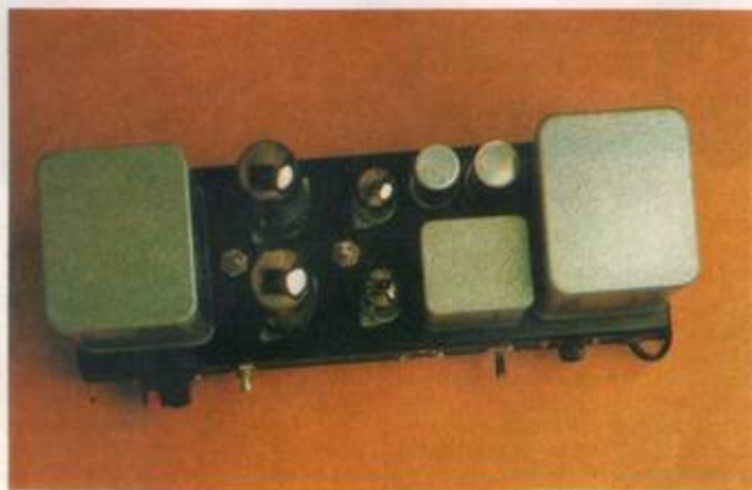
On peut ici remarquer la disposition rationnelle des divers éléments montés sur le châssis.
