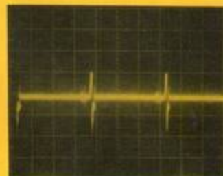
Voie X : 10 \mu s/div. Voie Y : 50 mV/div. Bruit résiduel sur l'alimentation +14,2 V
