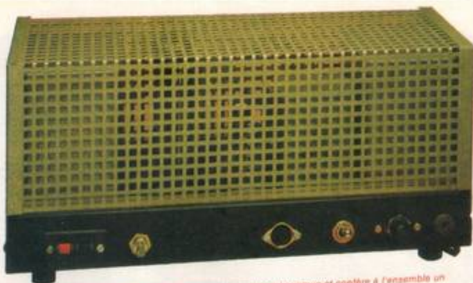
Le capot grillagé du coffret permet une bonne évacuation thermique et confère à l'ensemble un aspect pas du tout démodé.
