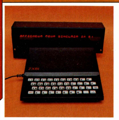
L'ensemble installé dans un boîtier obtenu par pliage à angle droit d'un rectangle de plexiglas fumé.
