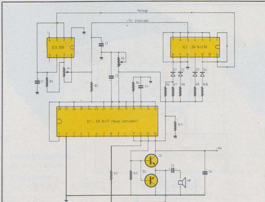
Figure 9 : Schéma de principe de la « serinette ».
