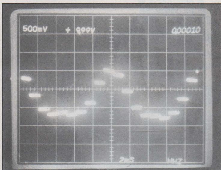
Sortie du comparateur de phase PC<sub>1</sub> (sortie échantillonneur bloqueur).
