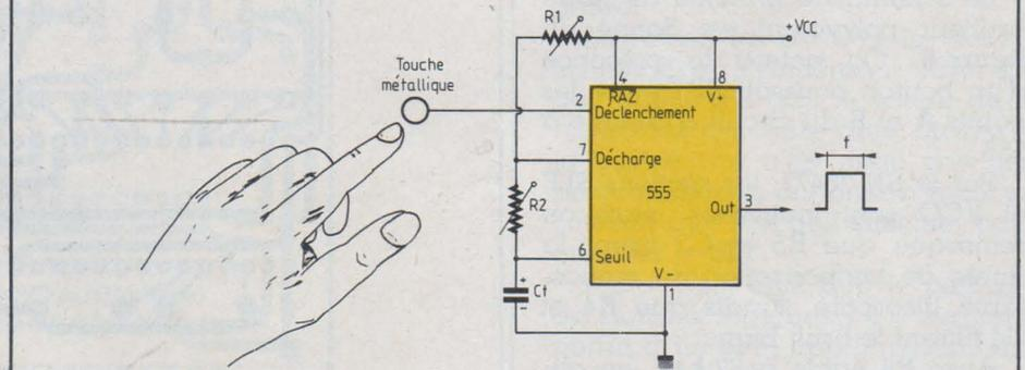
Figure 5 : Structure du monostable a touch-control.
