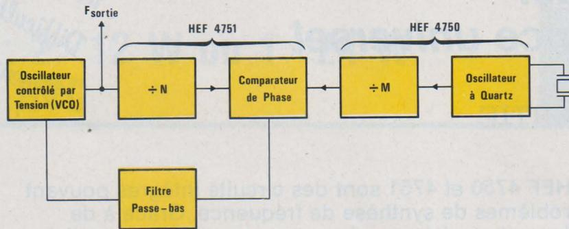
Figure 1 : Synthétiseur a PLL a boucle unique de rétroaction.
