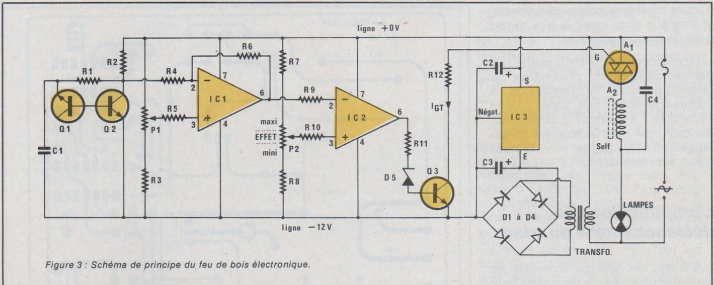
Figure 3 : Schéma de principe du feu de bois électronique.
