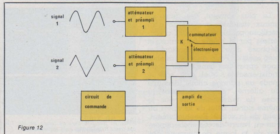
conformément aux indications simplifiées de la figure 12. Les signaux 1 et 2, appliqués sur chacune des entrées verticales, sont traités séparément dans les atténuateurs et les préamplificateurs des voies verticales correspondantes. A la sortie de ces étages, tous deux parviennent à un commutateur électronique K, actionné par des circuits de commande, et qui les dirige à tour de rôle vers l'unique amplificateur de sortie. Deux modes de répartition sont alors possibles.
