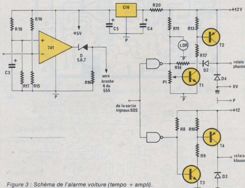
Figure 3 : Schéma de l'alarme voiture (tempo + ampli).
