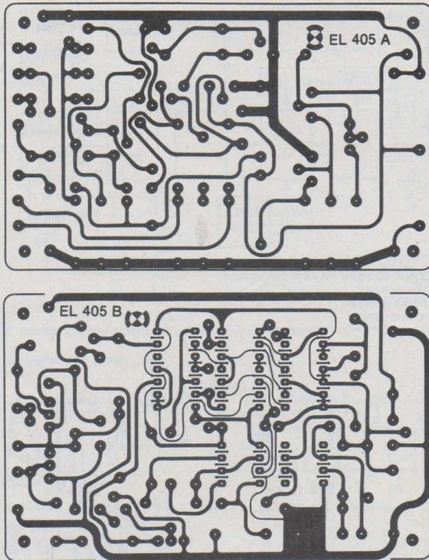
Figure 5 : Tracés des deux circuits imprimés.
