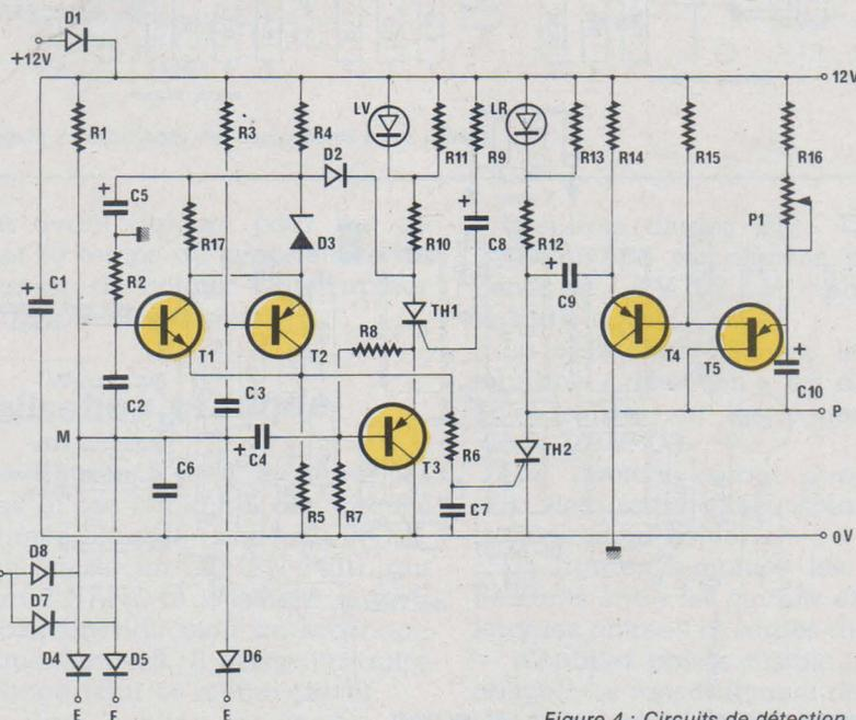
Figure 4 : Circuits de détection.
