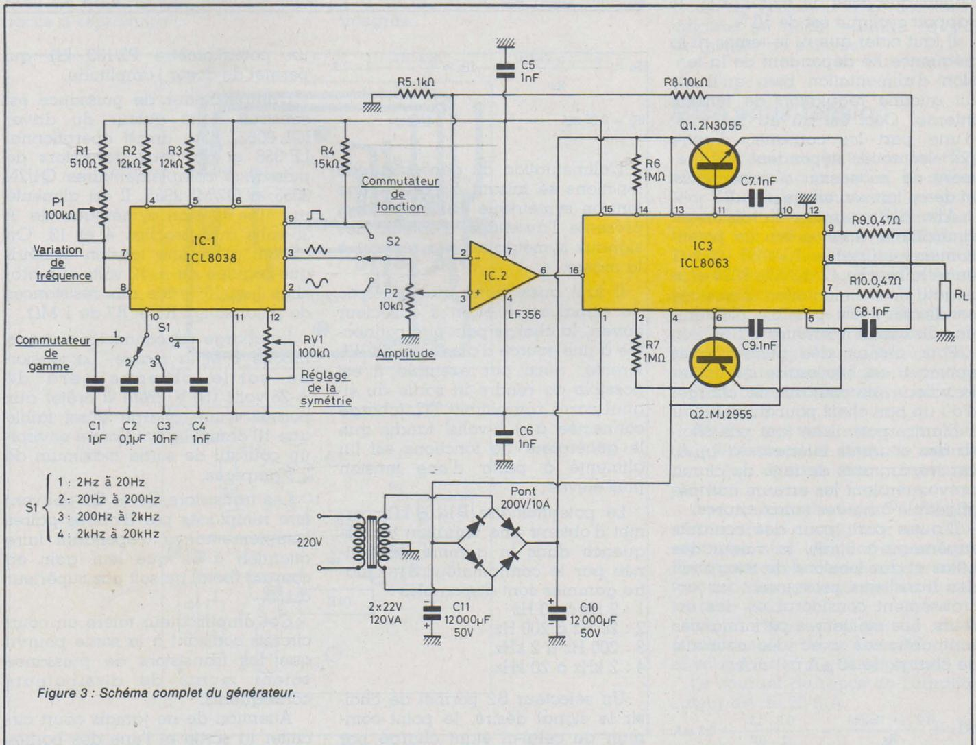
Figure 3 : Schéma complet du générateur.
