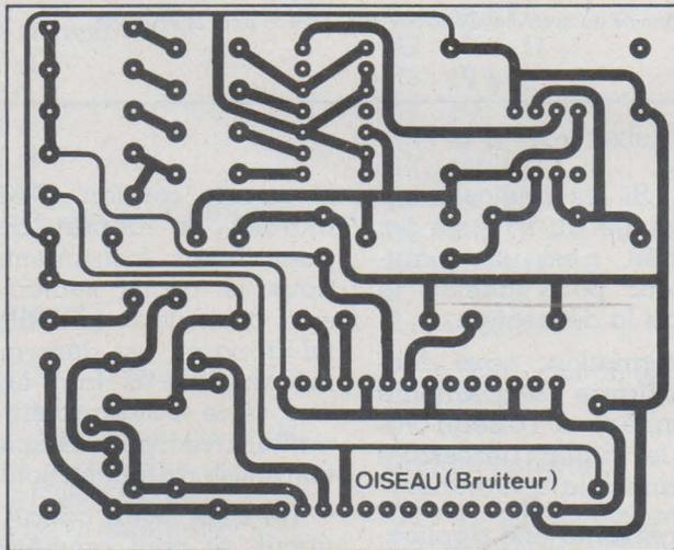
Figure 10 : Tracé du circuit imprimé « serinette ».
