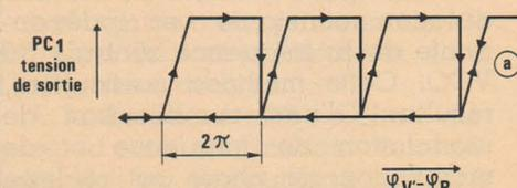
Figure 6a : Caractéristique de phase de PC1.
