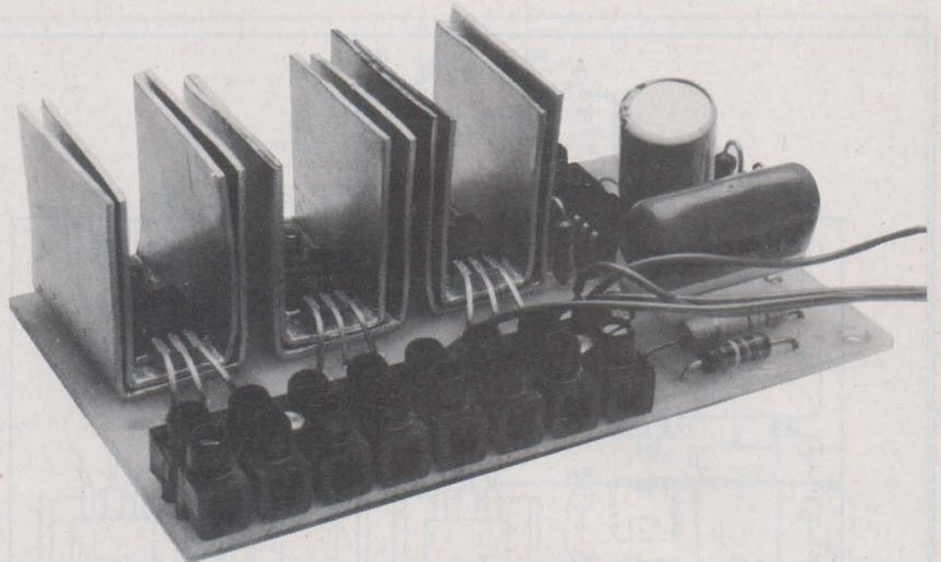
Dans le cas de la commande d'un moteur triphasé la modification du sens de rotation pourra être obtenue par permutation de deux fils de phase soit avant, soit après le relais.
