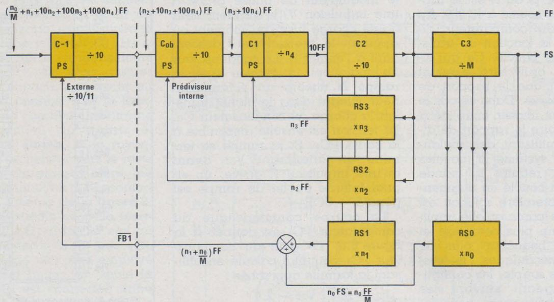
Figure 9 : PS : soustracteur d'impulsions.
