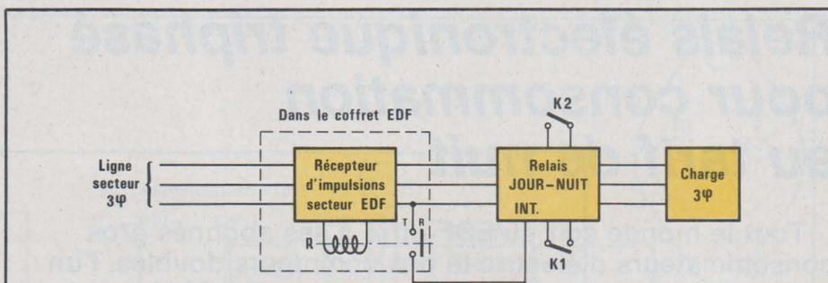
Figure 1 : Synoptique de fonctionnement du relais triphasé jour-nuit.
