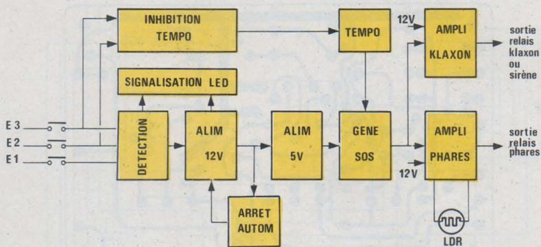
Figure 2 : Synoptique complet de l'alarme voiture.
