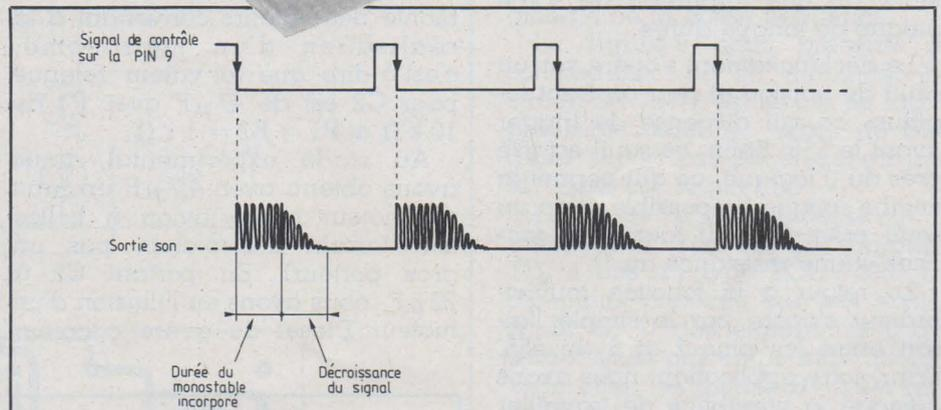
Figure 4 : Diagramme des temps pour un son commandé par monostable avec décroissance.
