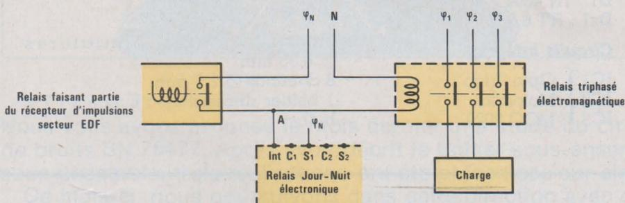
Figure 5 : Schéma de branchement du relais électronique 3-φ et jour-nuit dans le cas d'une installation déjà existante sur le plan de la commande.
