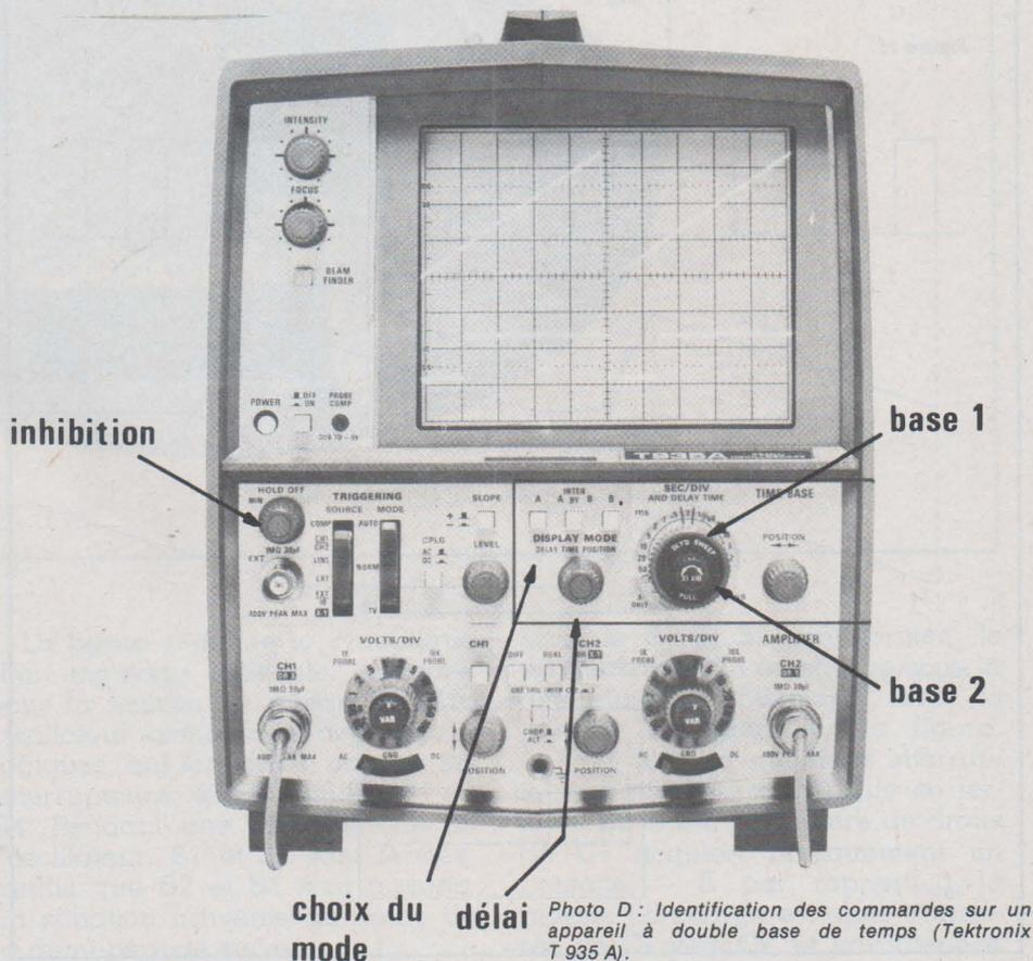
Photo D : Identification des commandes sur un appareil à double base de temps (Tektronix T 935 A).
