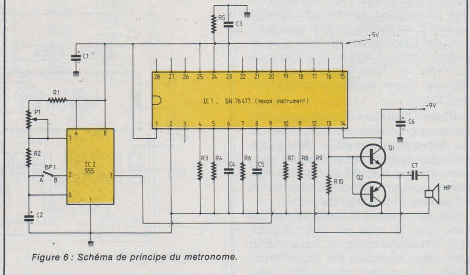
Figure 6 : Schéma de principe du metronome.
