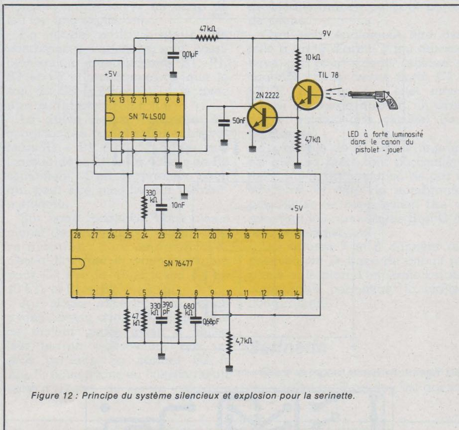
Figure 12 : Principe du système silencieux et explosion pour la serinette.
