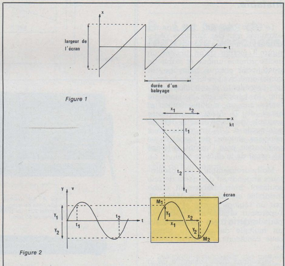
représenter graphiquement, sous forme d'une courbe décrite par le spot, les variations d'une tension électrique  $v = f(t)$ , fonction du temps. A chaque instant, l'élongation verticale  $y$ , et l'élongation horizontale  $x$ , sont proportionnelles aux différences de potentiel respectivement appliquées entre les paires de plaques correspondantes du tube cathodique.
