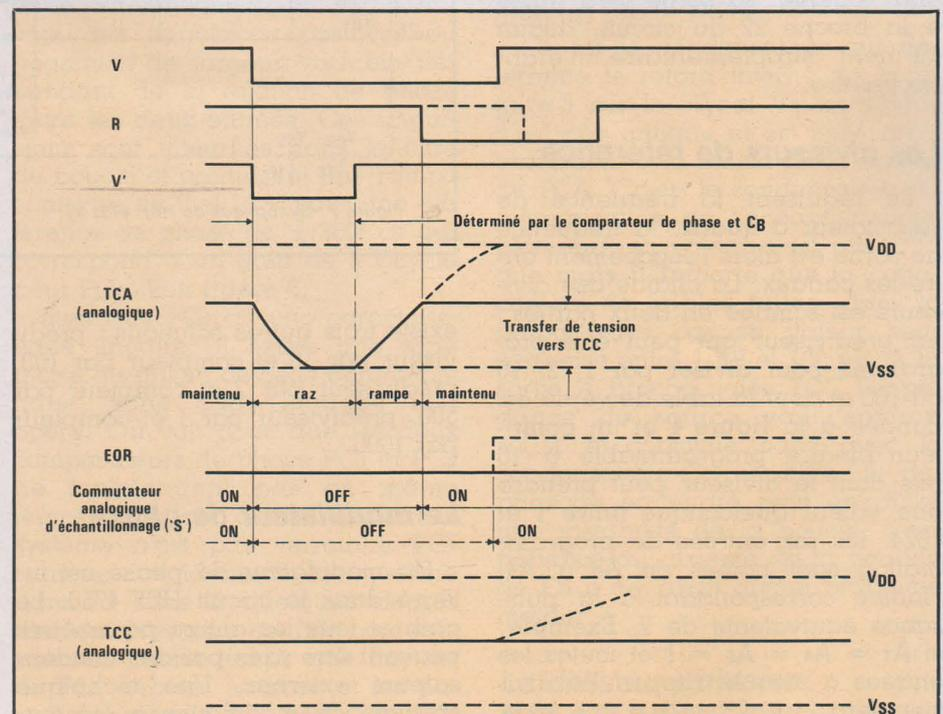
Figure 5 : Fonctionnement du comparateur de phase PC1.
