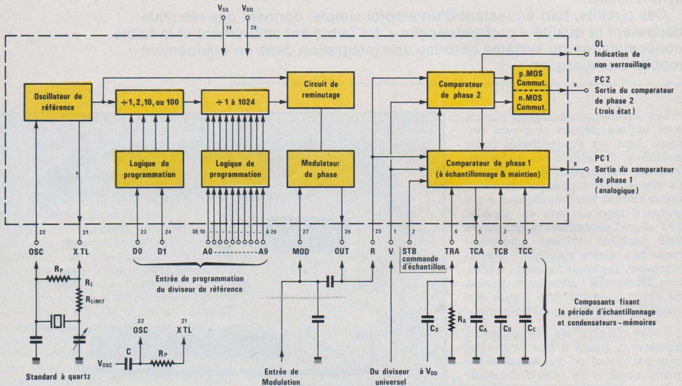
Figure 2 : Synoptique du synthétiseur de fréquence LN 1232/HEF 4750.
