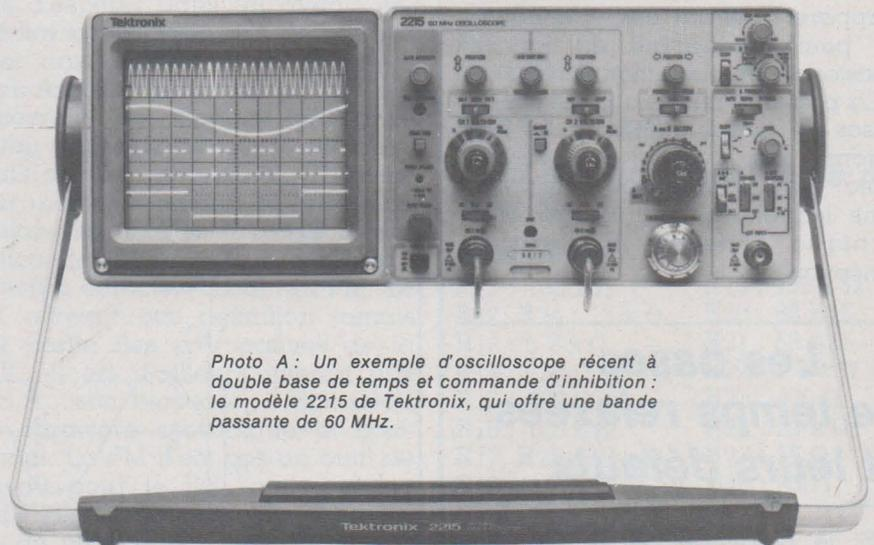
Photo A : Un exemple d'oscilloscope récent à double base de temps et commande d'inhibition : le modèle 2215 de Tektronix, qui offre une bande passante de 60 MHz.
