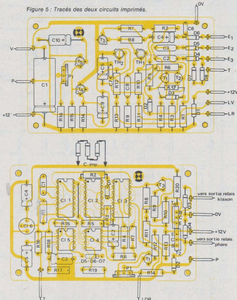
Figure 6 : Implantation des deux circuits imprimés.
