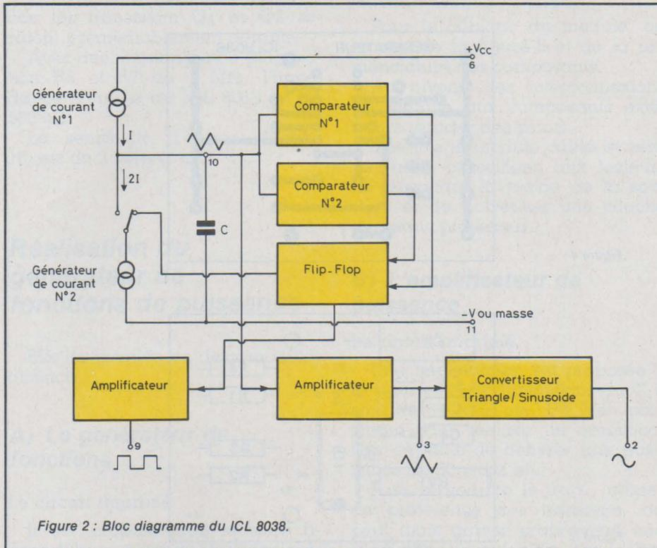
Figure 2 : Bloc diagramme du ICL 8038.
