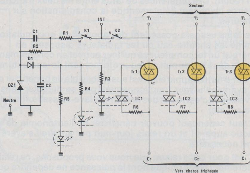
Figure 2 : Schéma de principe du relais jour-nuit.
