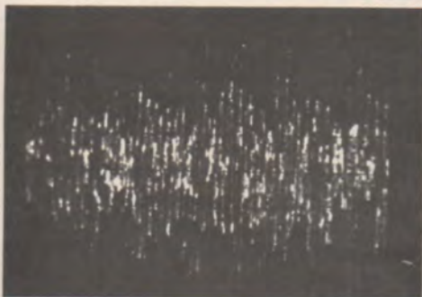
Oscillogramme figure 2 : Les tensions électriques disponibles à la sortie du micro excité par la parole, offrent une amplitude qui peut, selon les conditions, varier du millivolt à une dizaine de millivolts.
