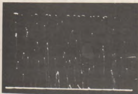
Oscillogramme fig. 3 : Après amplification, l'excursion en tensions alternatives, dépasse les six volts de l'alimentation : il se produit un écrêtage sur les pointes inférieures et supérieures.
