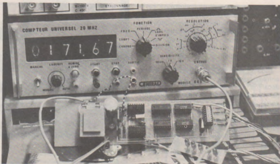
Photo 6 : Reglage de la periode du multivibrateur astable.
