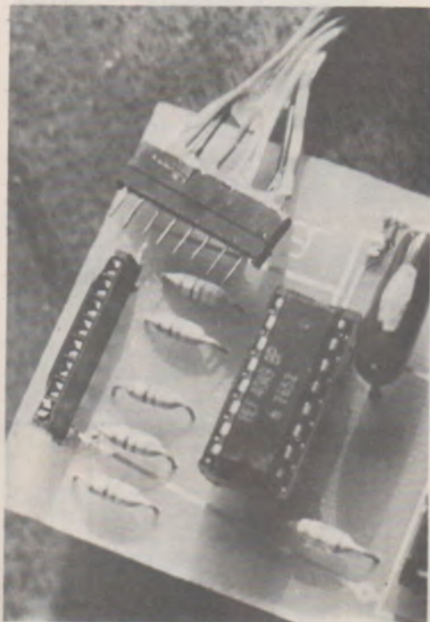
Photo 5 : Detail du connecteur des diodes LED
