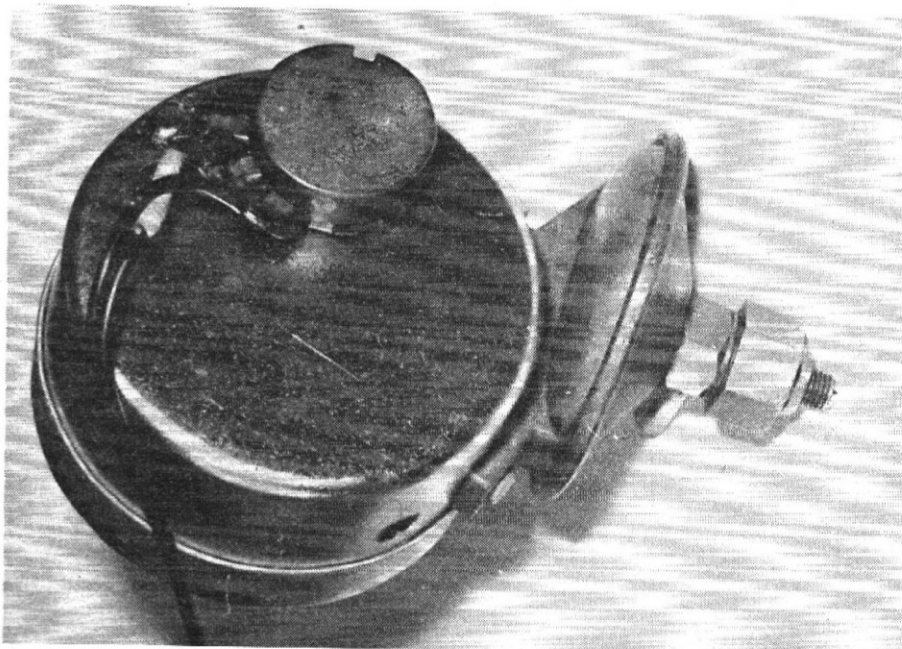
Vue de dos de la partie mécanique montrant le potentiomètre. Après réglage, la cosse devant être reliée à la masse a été soudée à la boîte de protection de la timonerie.
