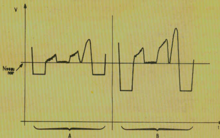
Figure 32 : conservation du niveau du noir dans l'amplificateur vidéo. En B, le gain vidéo est deux fois plus fort qu'en A : le signal est deux fois plus ample mais le niveau du noir est inchangé.
