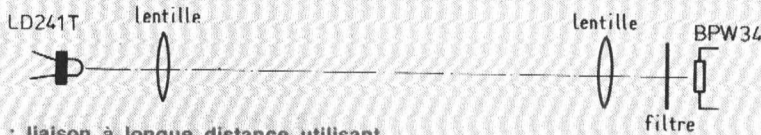
Figure 10 : liaison à longue distance utilisant des lentilles à l'émission et à la réception (l'alignement doit être extrêmement précis et les supports très stables).
