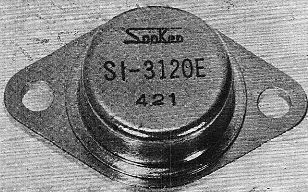
Le régulateur + 12 V intégré.
