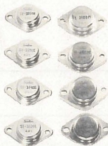
Régulateurs de tension hybrides SANKEN 5V - 12V - 15V et 24V (1,5 A)
