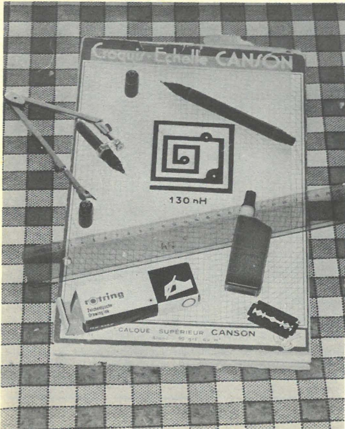
2 e opération : Dessiner à l'échelle 4 le motif géométrique retenu à l'aide d'un instrument à encre de Chine. Ajouter les pastilles correspondant aux éventuelles prises.
