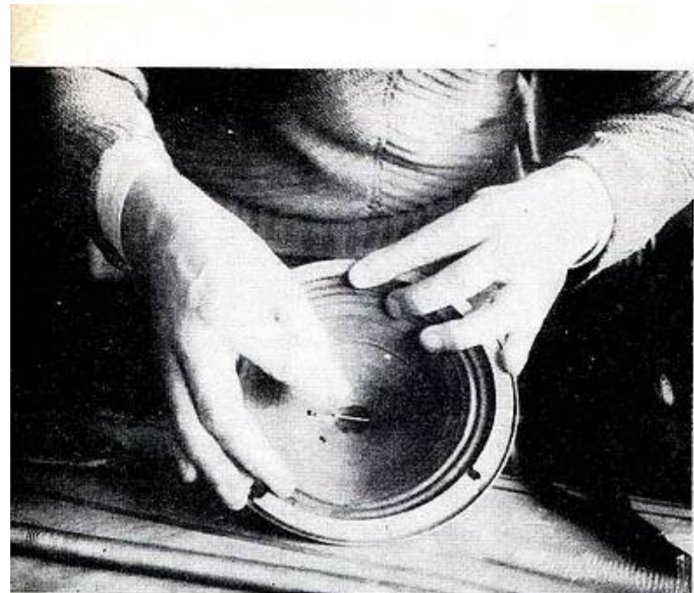
Le réalisateur a plié le U transmettant les vibrations aux ressorts et contrôle son emplacement. Au premier plan on aperçoit les ressorts.
