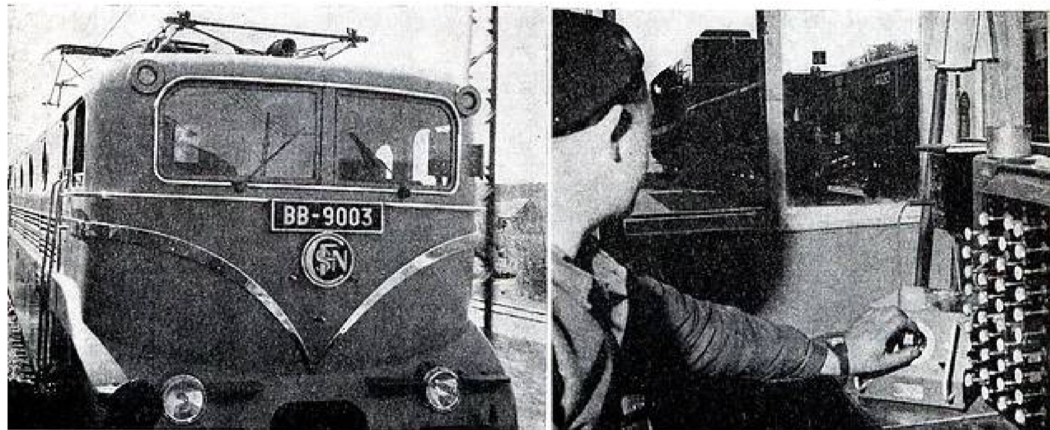
1. — Avril 1955, la BB 9003 télécommandée : 120 à l'heure sans pilote à bord !
