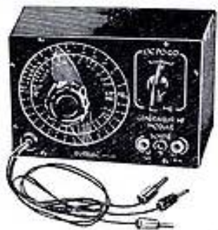
Vous monterez ce générateur HF en utilisant la technique des circuits imprimés.
