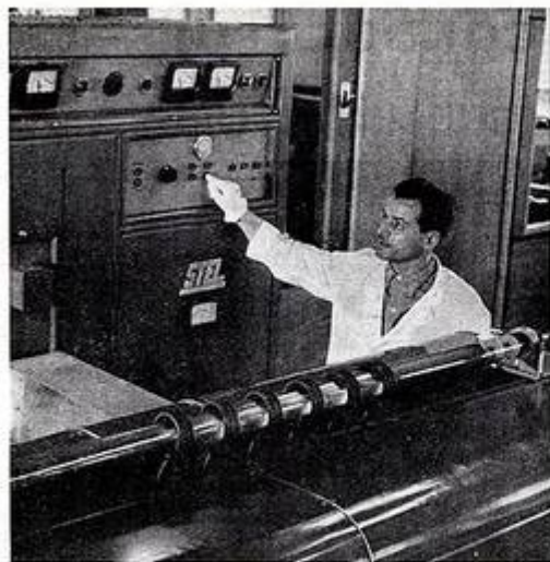
N° 2. — Machine à raffiner physiquement le germanium par « fusion de zone ». Le lingot à purifier est placé dans une nacelle de graphite, à l'intérieur du tube de quartz rempli d'hydrogène pur.
