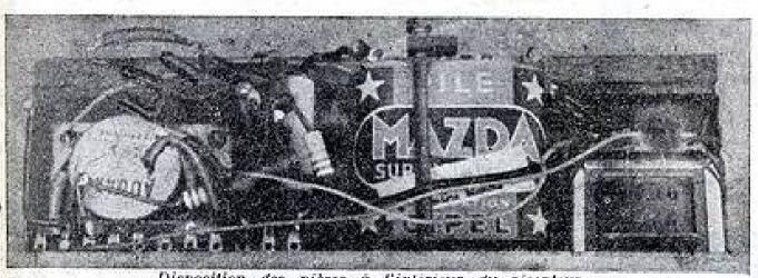
Disposition des pièces à l'interieur du récepteur. Malgré le faible volume de cet appareil, l'utilisation de transistors permet de réaliser un montage aéré, et h'offrant aucune difficulté de construction.
