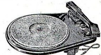
Platine 33-45 et 78 tours, permettant la lecture des disques anciens et modernes. Secteur **ALTERNATIF** 110 à 220 volts. 50 périodes. **BRAS ULTRA-LÉGER PIEZO ÉLECTRIQUE**. Saphir incorporé. (Supprime l'emploi d'aiguilles. Arrêt automatique). Encomb : 43 x 26 x
