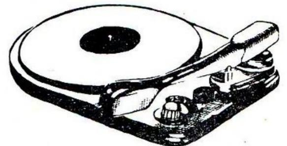
3 VITESSES RÉGLABLES (33, 45, 78 tours). Plateau matière moulée. Secteur alternatif 110 et 220 volts 50 p. Bras très léger avec cellule piézo réversible à saphirs incorporés Arrêt automatique. Encombrement : 340 x 260 x 138. Prix..... **13.900**
