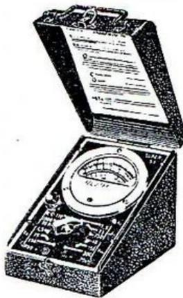
Contrôleur universel à cadre de grande précision. 1.000 ohms par volt en continu et alternatif jusqu'à 750 V. Milliampèremètre jusqu'à 150 mA, ohmmètre par pile incorporée, capacimètre par secteur alternatif 110 V 50 p. Monté en coffret métallique avec poignée. Cadran de 75 mm. Encombrement : 160 mm x 100 mm x 120 mm..... **8.500**
