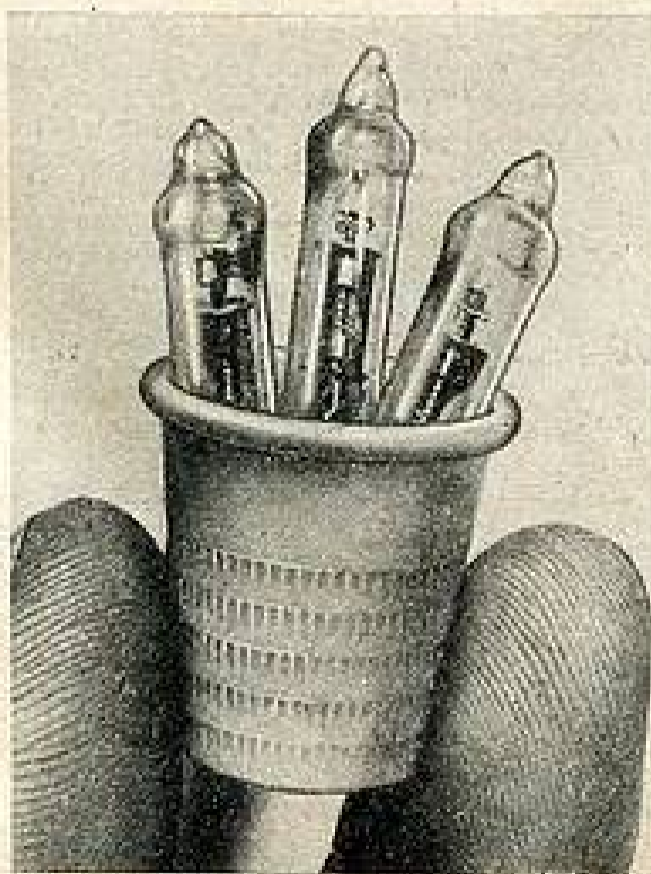
Trois valves D.F.66 Mullard dans un dé à coudre.
