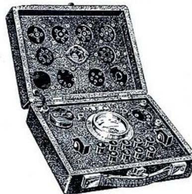
Révéle l'état mécanique du filament. Contrôle séparément chaque électrode. Décèle les courts-circuits. Mesure l'émission cathodique. Indique l'isolement filament cathode. Comporte tous les supports de lampes, y compris les supports américains. Loctal et gland. Ne pèse que 950 grammes. Fonctionne sur courants continu et alternatif 25 ou 50 périodes, sous 110 ou 220 volts. Livré avec **5.150**
